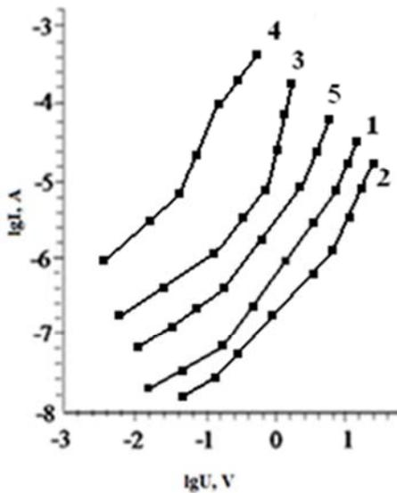
Fig. 3. CVC of  $Pb_{1-x}Mn_xTe$  ( $x=0.04$ ) thin film at  $T=80$  K 1)  $\Phi=0$ ; 2)  $\Phi=10^{15} cm^{-2}$ ; 3)  $\Phi=5 \cdot 10^{15} cm^{-2}$ ; 4)  $\Phi=2 \cdot 10^{16} cm^{-2}$ ; 5)  $\Phi=7 \cdot 10^{17} cm^{-2}$ .
